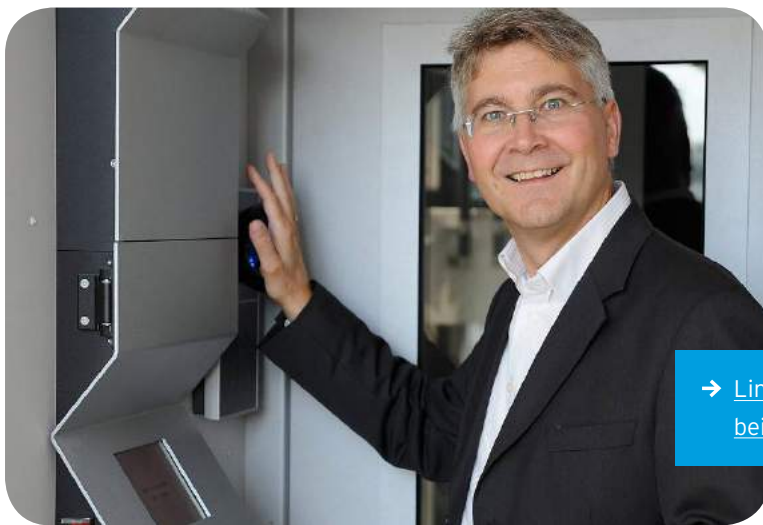
Sicherheitsschleuse mit Venenscanner (Ident-Center Solingen)
